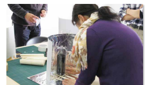
▲台紙の上に割りばしを置くのは、空気の流れにより容器の下からも温めるようにするため。
