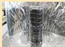
▲今回作成したソーラークッカー。身近な材料を使って作れます。
